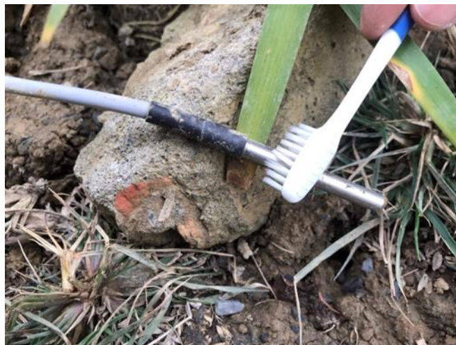
圖 3.7 清水刷洗溫度計表面示意圖
