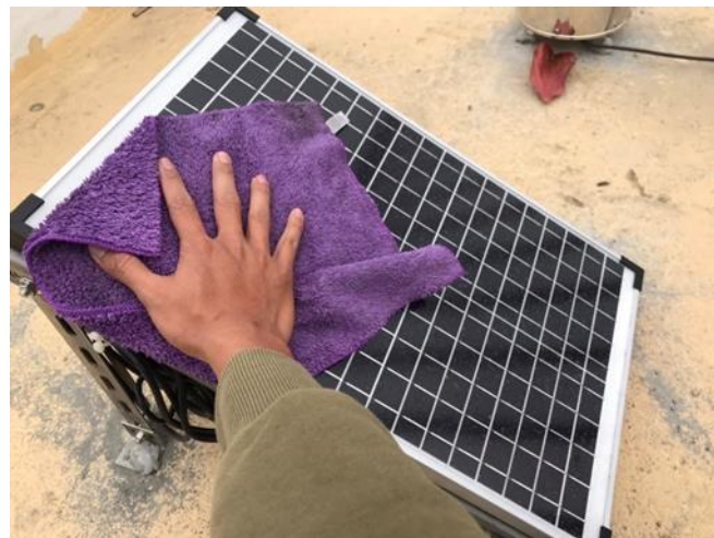
圖 3.11 太陽能板外觀以抹布擦拭示意圖
