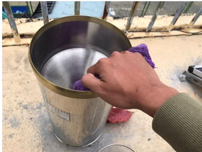
圖 3.9 雨量計外觀以抹布擦拭示意圖
