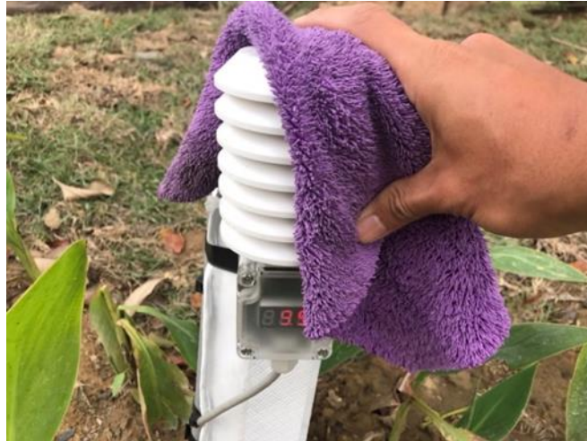
圖 3.10 溫溼度計外觀以抹布擦拭示意圖
