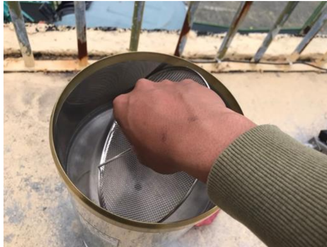
圖 3.8 清理雨量計濾網上雜物示意圖
