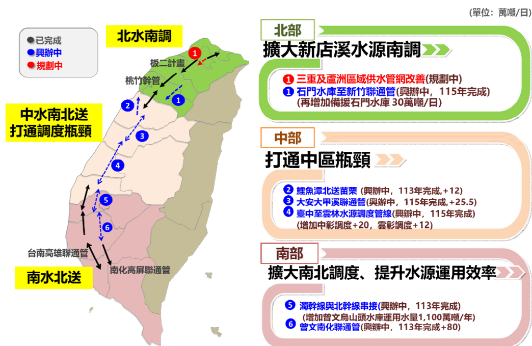
圖 1-3 珍珠串西部廊道供水管網
