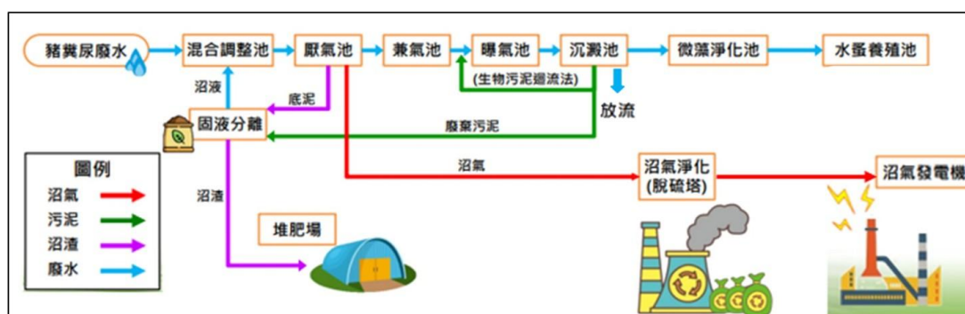
圖 39、內門畜牧廢水資源化中心處理流程
