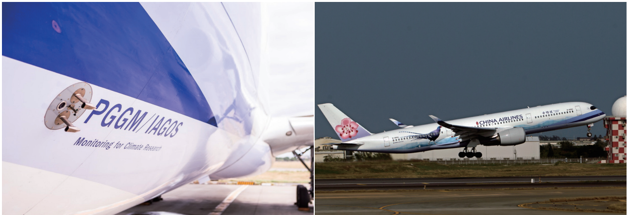
圖 8.4.2 中華航空公司於 A340-300 型客機上裝載全球觀測儀器系統
