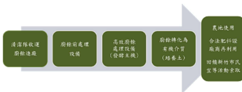
圖 3-4 高效廚餘處理廠區作業流程圖
