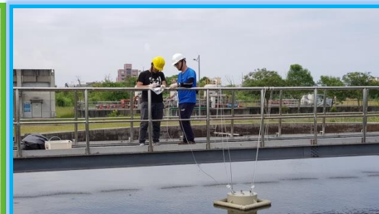
實地量測污(廢)水廠溫室氣體
