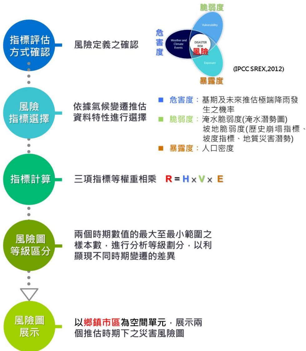
圖 4-28、氣候變遷風險圖評估流程
