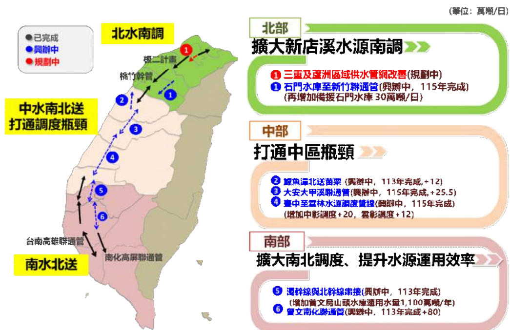
圖 1-3 珍珠串西部廊道供水管網
