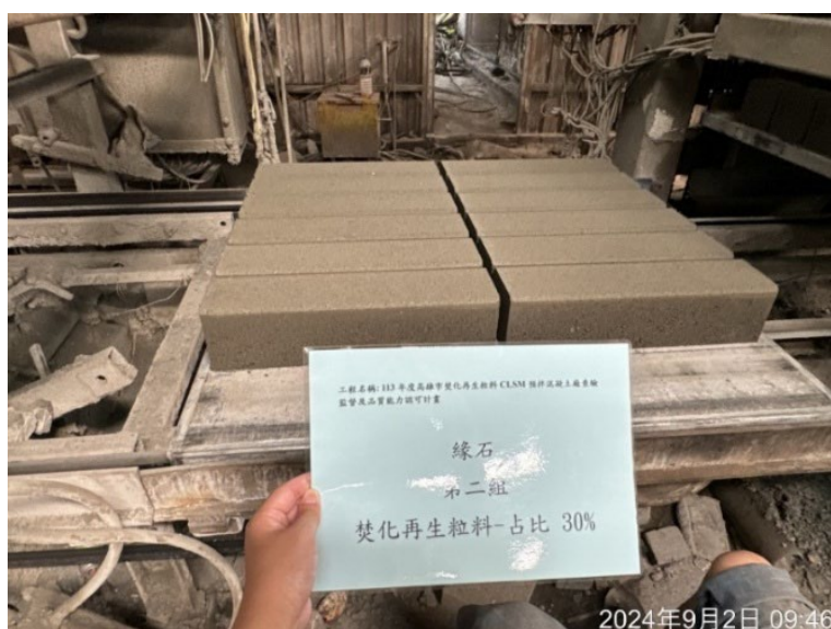
圖 28、焚化再生粒料作為 CLSM 之工程骨材
