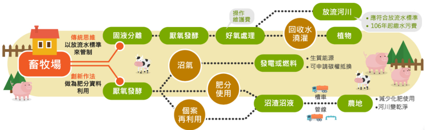
圖 23 畜牧糞尿資源化處理過程
