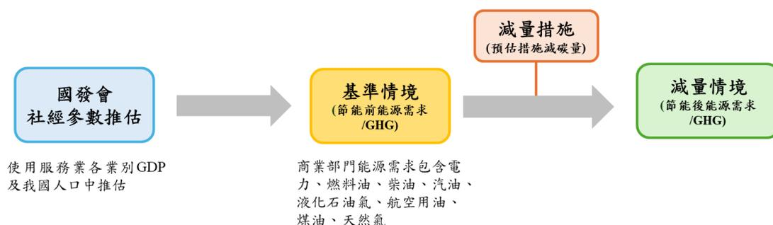
圖 9、商業部門能源需求與溫室氣體排放量之推估流程
