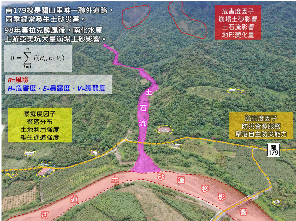
圖4.1-53 风险分析計算因子示意圖(以臺南市南化區關山里亞美坑溪為例)
