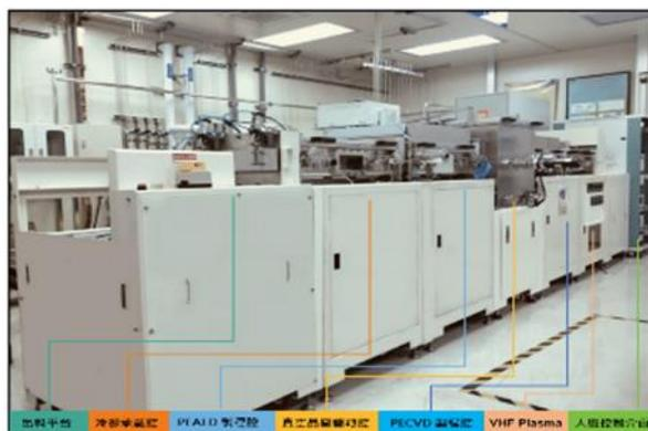
圖 2、多工連續式 TOPCon 太陽能電池薄膜沉積設備系統
