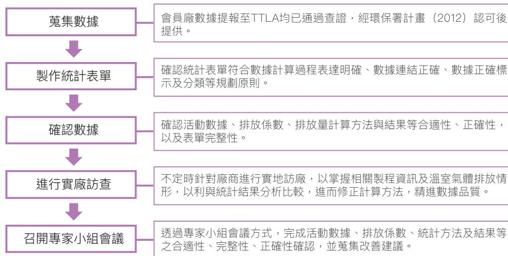
圖 4.6.5 積體電路或半導體製程排放統計 QA/QC 流程
