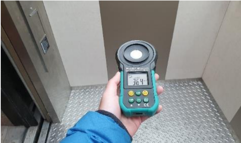
圖 18 公寓大廈節能輔導-空間最適照明照度量測
