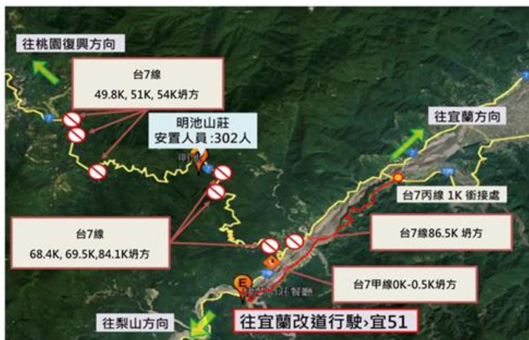
圖 2-7 尼莎颱風導致大同鄉重大崩塌災害環境示意圖
