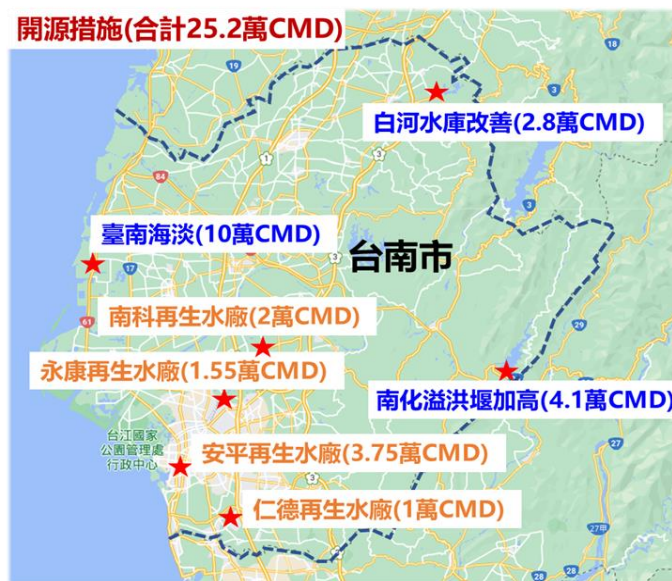
圖 3-12、臺南市再生水未來推動目標
