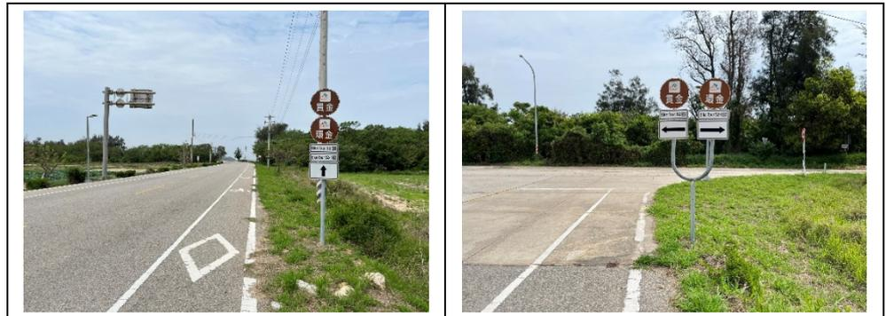
圖 2-6、自行車專用車道及 U 型桿標誌牌立柱
