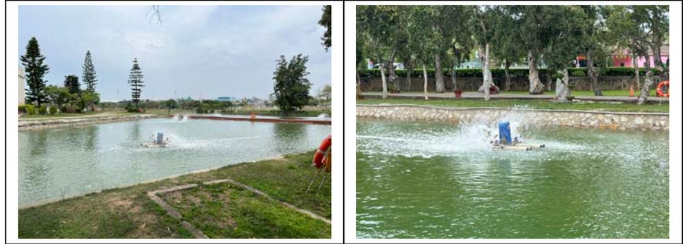
圖 2-9、水試所節能水車
