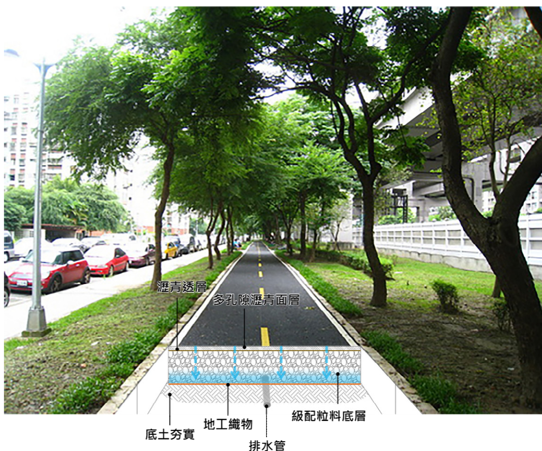
圖 3.2- 5 透水性瀝青鋪面構成示意圖
